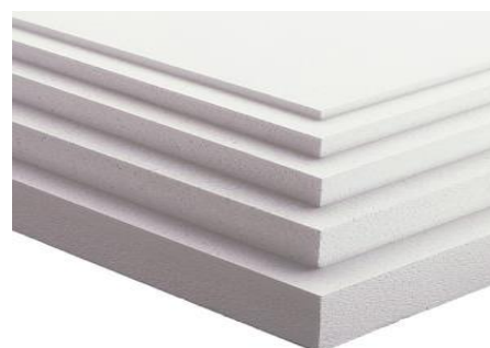
รูปที่ 15 ฉนวนประกอบผนังห้องเย็นแบบโพลีเอทิลีน (เหลือง) และฉนวนแบบโพลีสไตรีน (ขาว)
