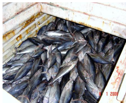
รูปที่ 14 ถังโครงสร้างเหล็กพร้อมท่อเย็นขนาดความจุประมาณ 25 ตัน สำหรับดองและแช่แข็งทูน่า บนเรือประมงอวนล้อม (ระบบน้ำเย็น และระบบไบน)
