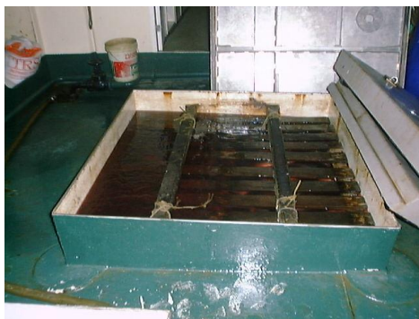
รูปที่ 14 ถังโครงสร้างเหล็กพร้อมท่อเย็นขนาดความจุประมาณ 25 ตัน สำหรับดองและแช่แข็งทูน่า บนเรือประมงอวนล้อม (ระบบน้ำเย็น และระบบไบน)
