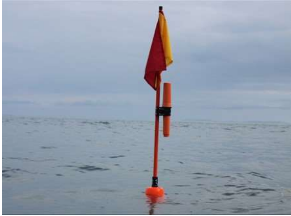
ภาพที่ 20 ท่อนลอยประกอบระบบหรืออุปกรณ์แสดงตนอัตโนมัติ (Automatic Identification System หรือ AIS) (ที่มา: https://www.superyachtmarinestore.com/ais-fishing-buoy-tracker/ )
