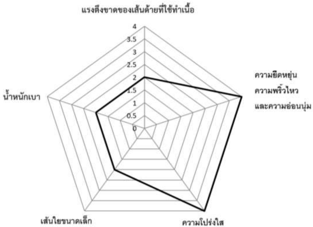
ภาพที่ 30 แสดงคุณสมบัติของวัสดุประมงที่เหมาะสมกับการสร้างอวนติดตา (ที่มา: วรวิทย์ 2559)
