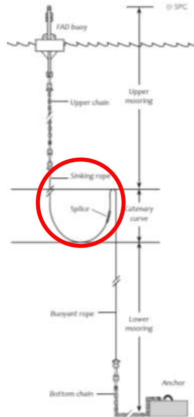
ภาพที่ 23 แสดงการเผื่อความยาวเชือกทุ่นให้มากกว่าความลึกน้ำ ตัวอย่างซึ่งแบบมีสมอ (ที่มา: Beverly, S., Griffiths D. & Lee, R. 2012)
