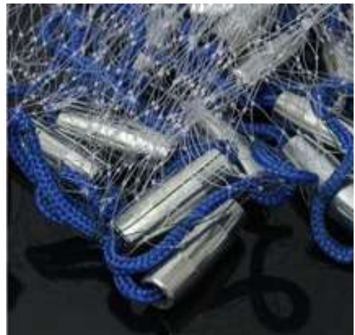
ภาพที่ 28 แสดงน้ำหนักถ่วงและคร่าวล่างอวนติดตาม
