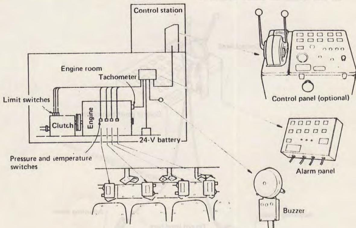
Fig. 1 Wiring diagram
