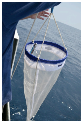
รูปที่ 2 ถุงลากแพลงก์ตอนสัตว์ ขนาดตา 315 ไมครอน ที่ใช้เก็บตัวอย่าง
