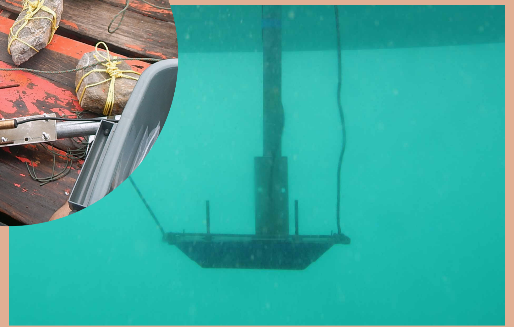
หัวส่งคลื่นสัญญาณเสียง (Transducer) ที่ติดตั้งไว้ที่ท้องเรือ
