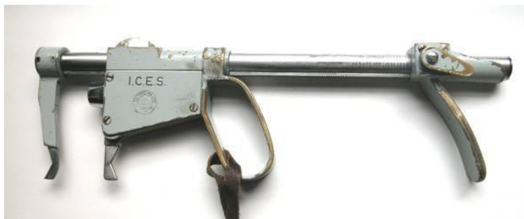
ภาพที่ 11 อุปกรณ์วัดขนาดช่องเปิดอวนแบบสปริง (Longitudinal spring Loaded Mesh Gauge)
