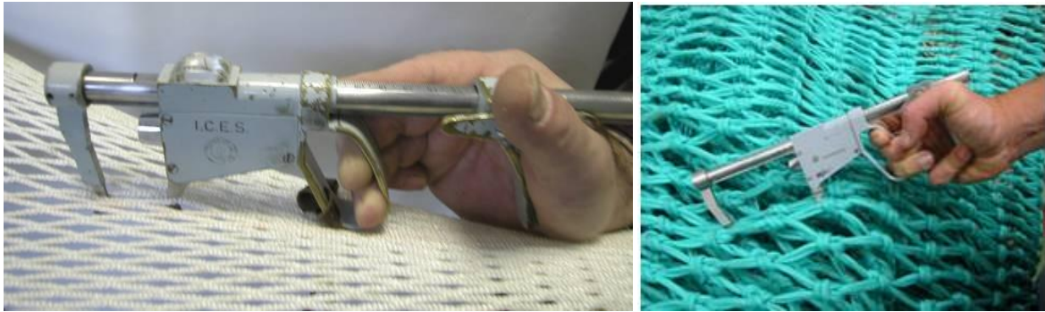
ภาพที่ 13 วิธีใช้อุปกรณ์วัดขนาดช่องเปิดอวนแบบสปริง (Longitudinal spring Loaded Mesh Gauge)
