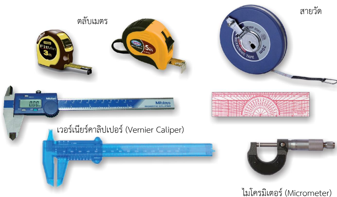
ภาพที่ 5 อุปกรณ์ที่ใช้ในการวัดขนาดตาอวน และขนาดเส้นด้ายทออวน (ภาพโดย ณรงค์ เรืองสืวะกุล)
