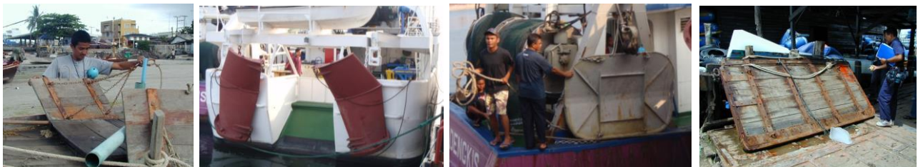
ภาพที่ 7) ลักษณะแผ่นตะเฒแบบต่างๆ (ที่มา Isara Chanrachkij)
